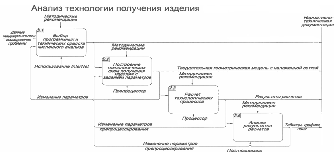
Сурет 13 – MSC.SuperForge көмегімен өнімді алу технологиясын талдау
